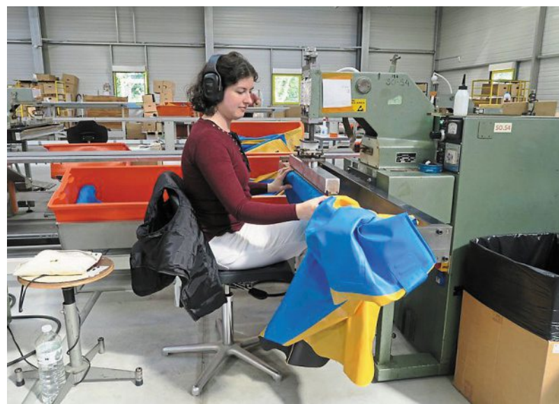
La cotte « Salsa » est un assemblage de 21 morceaux, découpés et assemblés par des machines.
